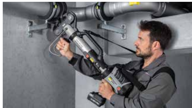
Leidžia presuoti storasienį plieną iki 4 colių: Pressgun-Press Booster.
