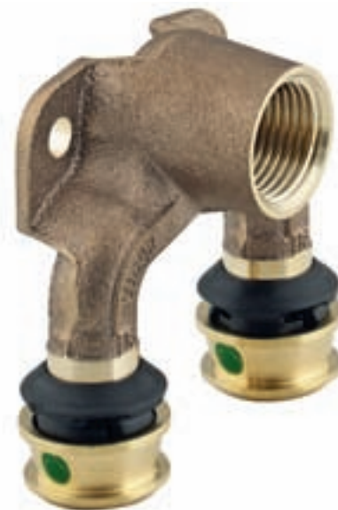
Bild 3: Bei durchströmten Wandscheiben wird das Trinkwasser hygienisch optimal regelmäßig bis direkt an der Zapfstelle ausgetauscht. Zudem sind die Druckverluste deutlich niedriger als beispielsweise bei einer T-Stück-Installation.
