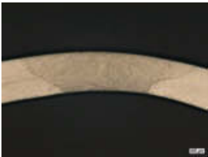
Soldadura WIG convencional.
