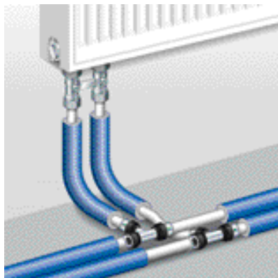
1–36 pav. Tiesioginis radiatoriaus prijungimas
