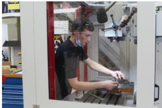
Leon Seifert, der seine Ausbildung zum Industriemechaniker bei der Viega GmbH & Co. KG in Großheringen erfolgreich absolvierte, spannt an der Fräsmaschine ein Werkstück zum Bearbeiten ein.
