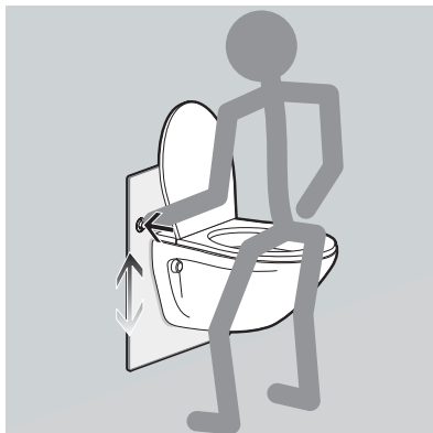
Fig. 2 – 68 Scaun de WC – ajustarea înălțimii în sus
