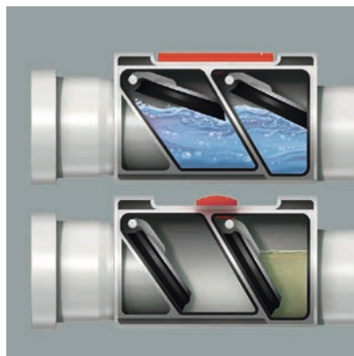
Fig. 3 – 158 Siguranță dublă împotriva refulării
