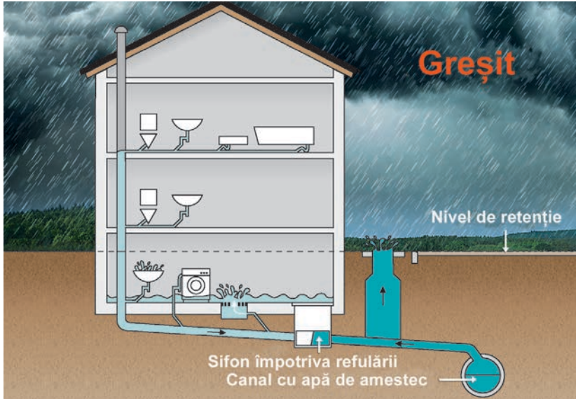
Fig. 3 – 150 Sifon împotriva refulării – amplasare greșită
