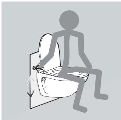
Fig. 2 – 67 Scaun de WC – ajustarea înălțimii în jos
