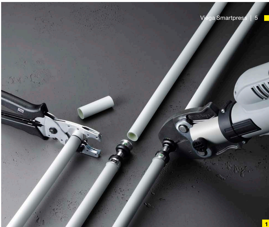
Se elimină calibrarea dificilă: se taie la lungime, se introduce, se presează și este gata.
