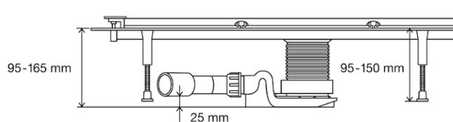
Регулируется также по высоте: монтажную высоту душевого лотка можно установить в диапазоне от 95 до 165 мм.
