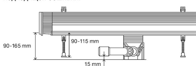
Регулируется также по высоте: монтажная высота от 90 до 165 мм.
