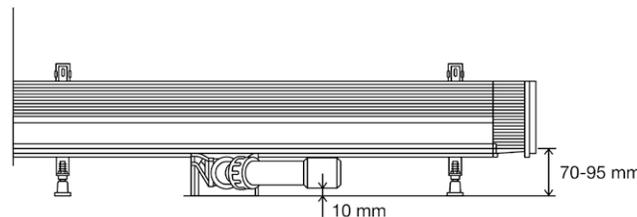
Чрезвычайно низкий: специально для ремонтных работ монтажная высота уменьшена до 70 мм.
