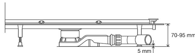
Чрезвычайно низкий: вместе со сливом специально для ремонтных работ монтажная высота не превышает 70 мм.
