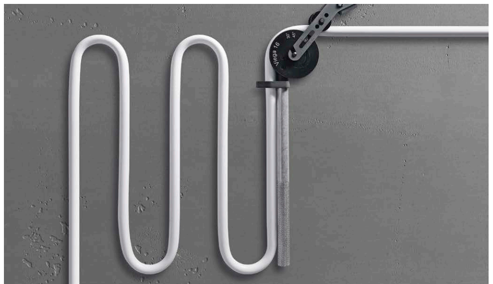
Pomocou ohýbacieho nástroja sa dajú hravo vytvárať čisté polomery.
